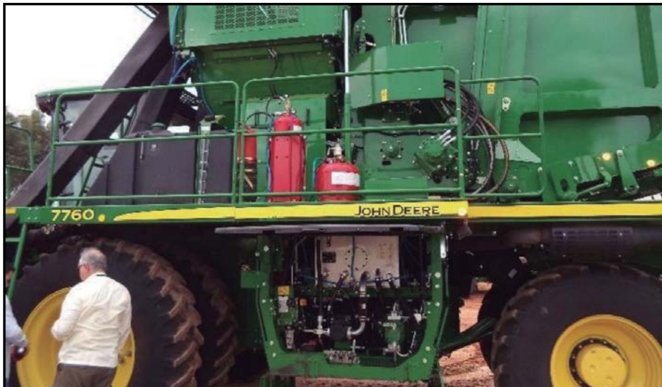
Figura 8. Equipamento de prevenção de incêndios instalado em colhedora de algodão.
