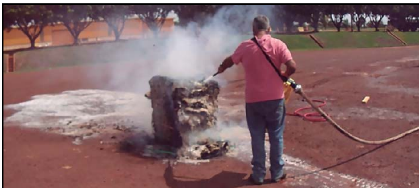
Figura 9. Demonstração de combate a incêndio em fardo comercial de fibrilha utilizando equipamento aplicador de Líquido Gerador de Espuma (LGE).
