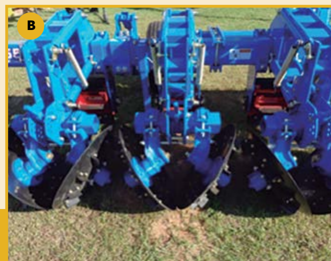
Figura 1. Arrancador de discos em “V” (A) e detalhes dos discos do arrancador (B). Fotos: Odilon R. R. F. Silva (A) e Julio Bogiani (B).
