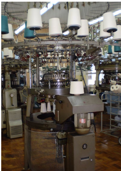
Figura 32. Tear circular alimentado por cones de fios, alimentação das agulhas e tecido de malha por trama em produção (Foto: Jorge José de Lima)
