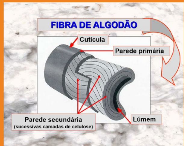
Figura 6. A estrutura da fibra de algodão de forma geométrica (Fonte: Zellweger Uster, Uster Product News, Set. 1992)
