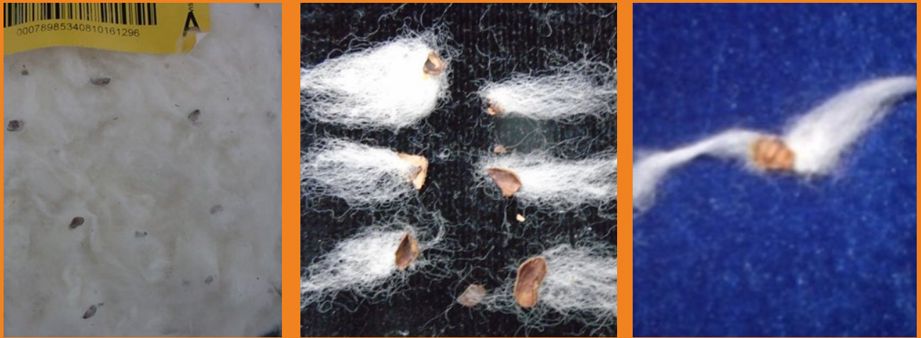
Figura 9. Algodão com seed-coat neps (SCN), seed coat fragments (SCF) ou cometas (Foto: Jorge José de Lima)
