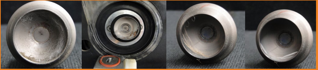
Figura 18. Presença de micropó, caule, juta e polipropileno nos rotores de fiação (Foto: Jorge José de Lima)
