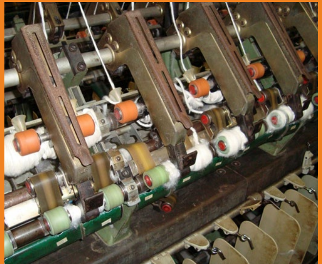
Figura 11. Capulhos de algodão com açúcares e presença de fumagina; enrolamento de algodão nos cilindros do filatório (Foto: Jorge José de Lima)
