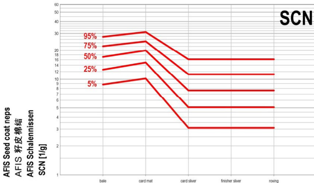
Figura 10. Comportamento da quantidade de SCNs por grama ao longo do processo de fiação (Fonte: USTER STATISTICS 2013)
