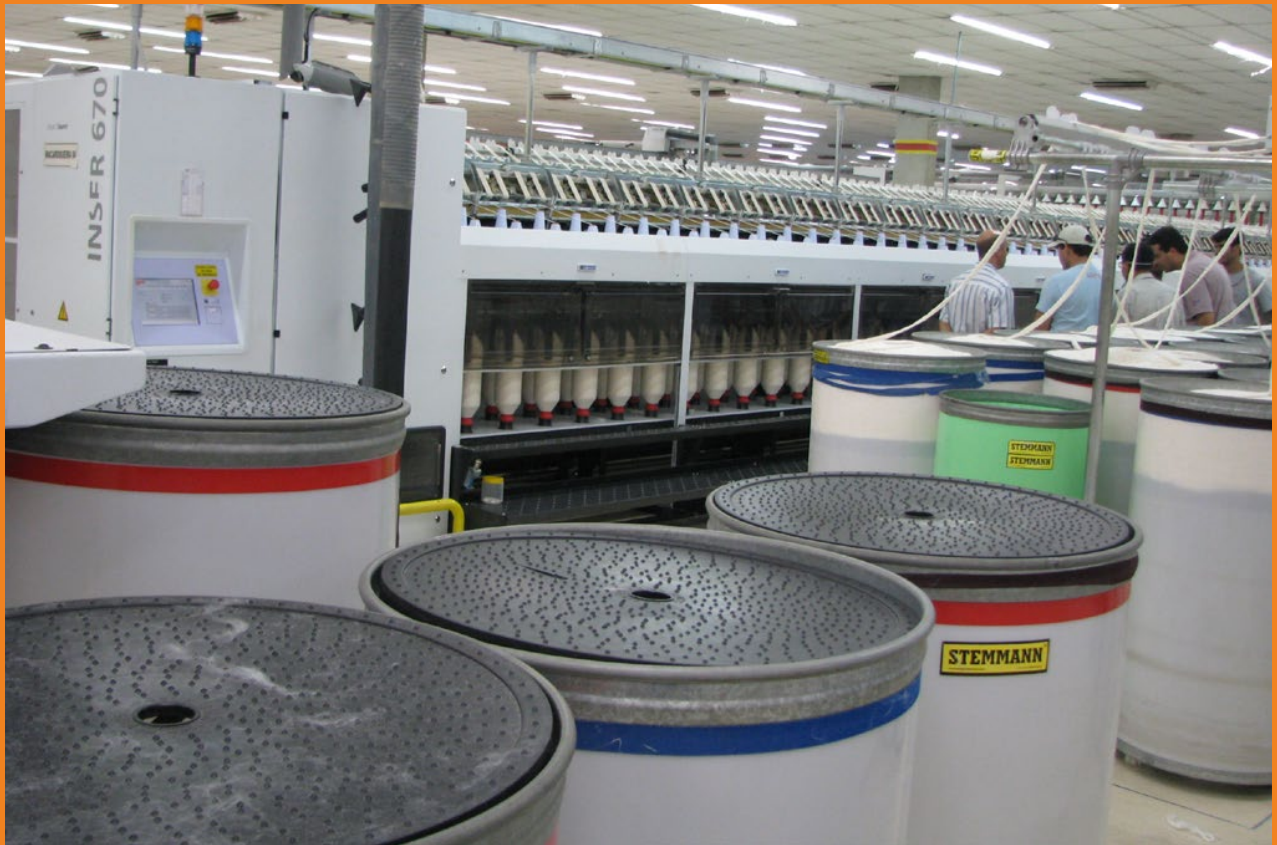
Figura 25. Maçaroqueira alimentada por fitas de passadores e pavios em produção (Foto: Jorge José de Lima)
