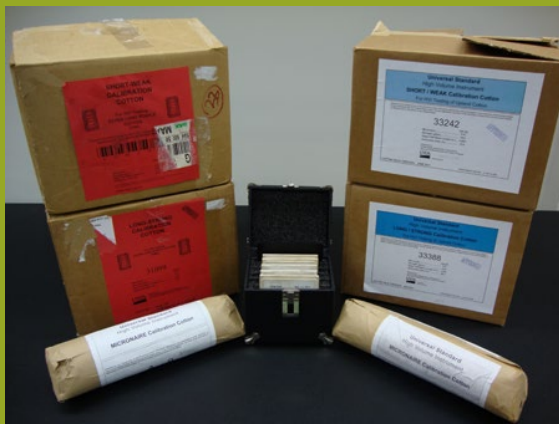
Figura 26. Os algodões e azulejos padrões de calibração para os instrumentos do tipo HVI (Fotos: J. J. de Lima)
