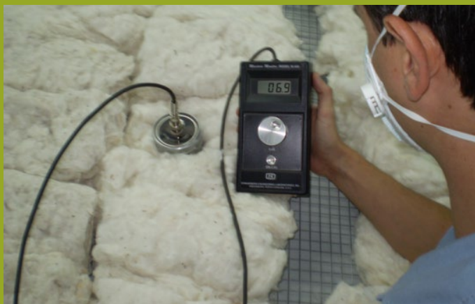
Figura 23. Condicionamento passivo das amostras de algodão nas salas de condicionamento e ensaio da Amipa e da Unicotton (Fotos: J. J. de Lima)
