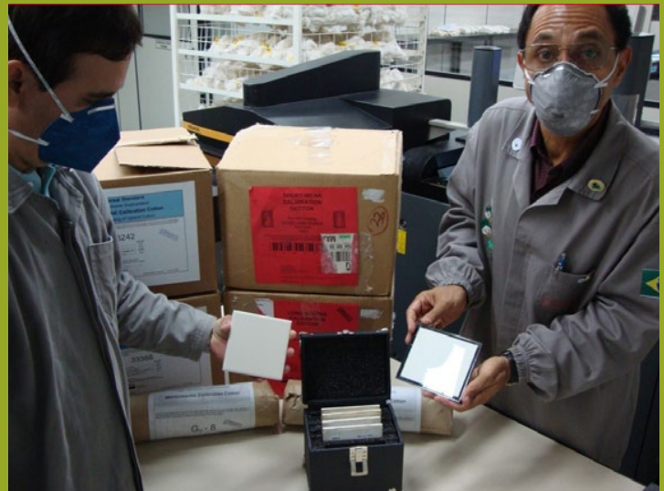
Figura 26. Os algodões e azulejos padrões de calibração para os instrumentos do tipo HVI (Fotos: J. J. de Lima)
