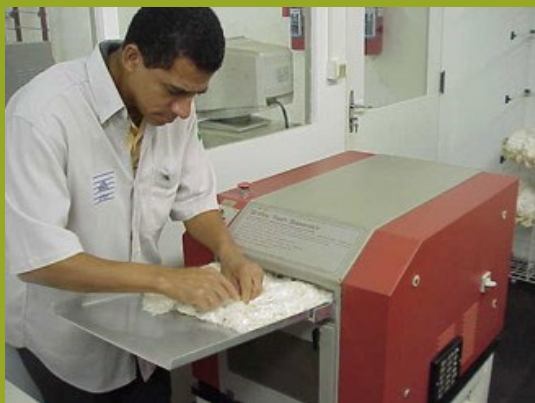
Figura 53 O Shirley Analyser Trash Separator, o material fibroso, sujeira, poeira e micropó (fotos: J. J. de Lima)
