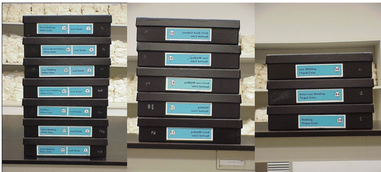
Figura 9. As quinze caixas dos padrões físicos universais para o algodão americano Upland de fibras curta e médias (White Color, Spotted Color e Tinged Color) (Fotos: J. J. Lima)
