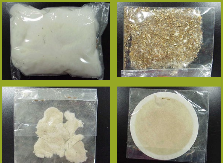
Figura 53 O Shirley Analyser Trash Separator, o material fibroso, sujeira, poeira e micropó (fotos: J. J. de Lima)
