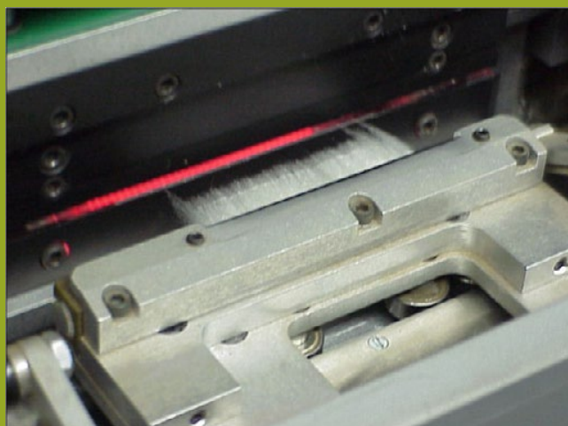
Figura 39. Medição da resistência e do alongamento à rotura da fibra de algodão pelo dinamômetro do instrumento do tipo HVI (Fotos: J. J. de Lima; fonte: Spinlab, Sistema 900 HVT. São Paulo, Textor)
