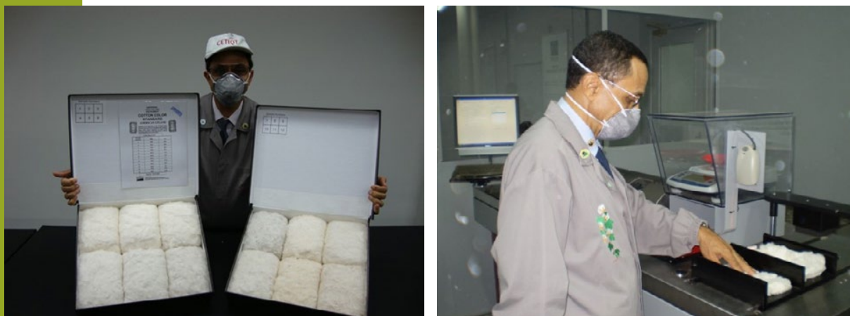
Figura 47. Caixas dos padrões universais, dos algodões de calibração para o HVI, a operacionalização do colormeter/trashmeter (Fotos: J. J. de Lima)
