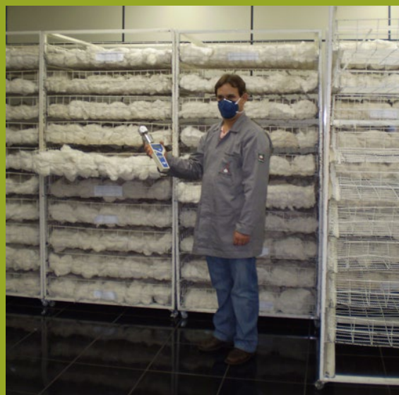
Figura 23. Condicionamento passivo das amostras de algodão nas salas de condicionamento e ensaio da Amipa e da Unicotton (Fotos: J. J. de Lima)
