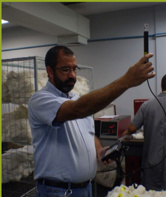
Figura 20. Mensuração, acompanhamento e controle da temperatura e umidade relativa do ambiente das salas de condicionamento e ensaio do Laboratório Têxtil do Fiesc/Senai (Fotos: J. J. de Lima)
