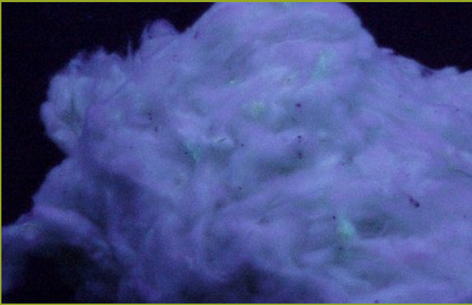
Figura 11. Algodão fermentado, com colônias de microrganismos e fibras com efeito cavitoma, visto por meio das lentes de um microscópio (Fotos: J. J. de Lima e Standard tests on fibres and yarns in the Schlafhorst Textile Laboratory)
