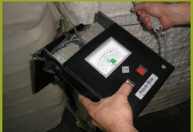
Figura 5. Medição da taxa de umidade na base seca nos fardos de algodão em pluma com medidores de umidade de método indireto (Foto: J. J. de Lima)
