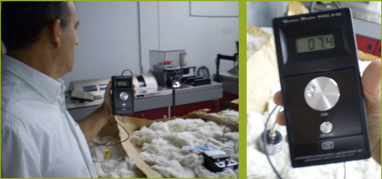
Figura 22. Mensuração da taxa de umidade em relação à massa seca das amostras no ambiente laboratorial da Unicotton (Fotos: J. J. de Lima)
