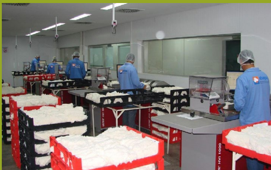
Figura 21. Distribuição dos sensores que mensuram continuamente a temperatura e a umidade relativa do ar da sala de classificação tecnológica da Abapa (Fotos: S. Brentano)
