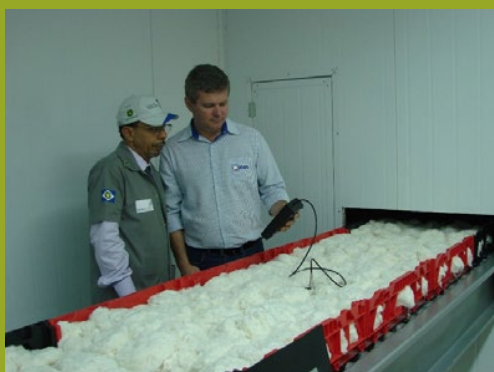
Figura 24. Condicionamento ativo das amostras de algodão nas salas de condicionamento e ensaios da Unicotton e da Abapa (Fotos: J. J. de Lima)
