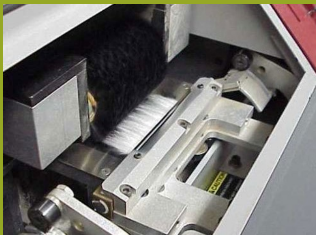
Figura 39. Medição da resistência e do alongamento à rotura da fibra de algodão pelo dinamômetro do instrumento do tipo HVI (Fotos: J. J. de Lima; fonte: Spinlab, Sistema 900 HVT. São Paulo, Textor)
