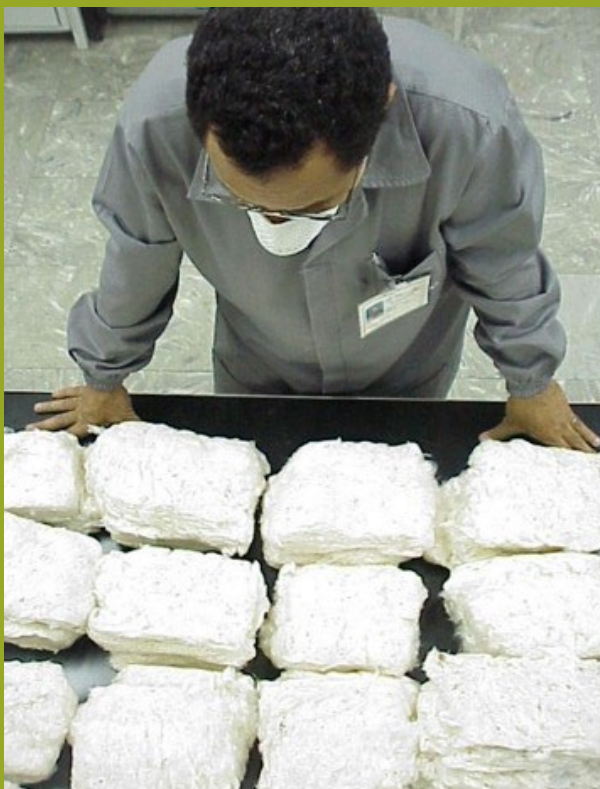
Figura 15. Malas de amostras abertas sobre as mesas de classificação, para que o classificador, verifique se há amostras em situação desclassificante (Fotos: J. J. de Lima)
