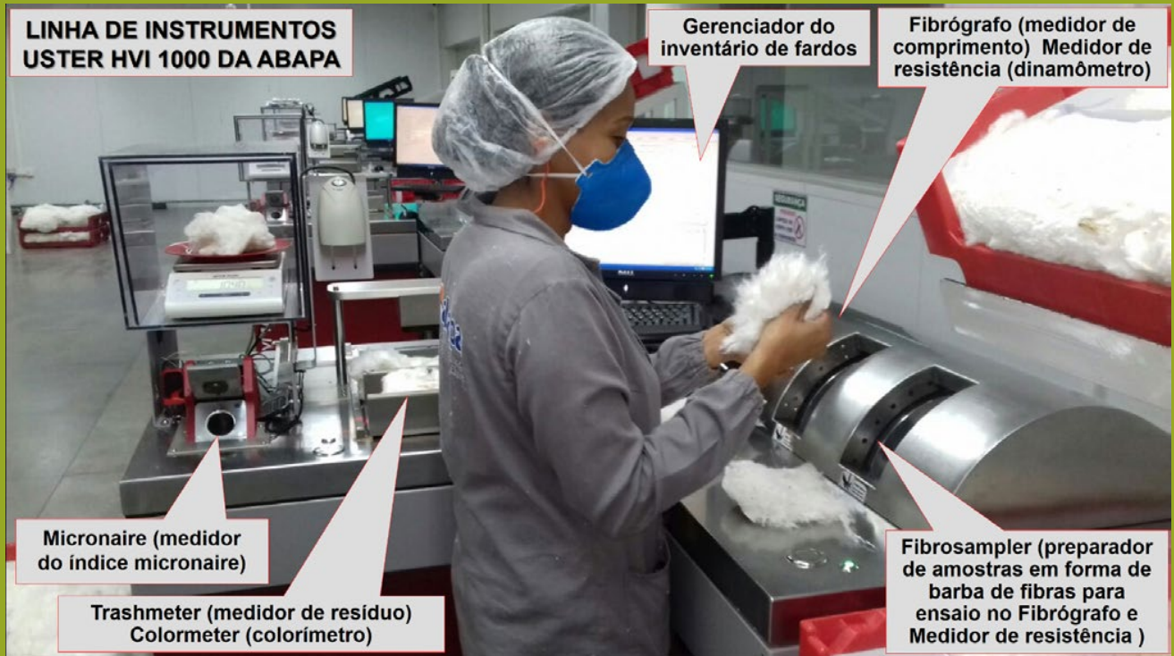
Figura 27. Ensaios nas amostras de um lote de fardos de algodão em pluma num instrumento Uster HVI 1000 (Foto: J. J. de Lima)
