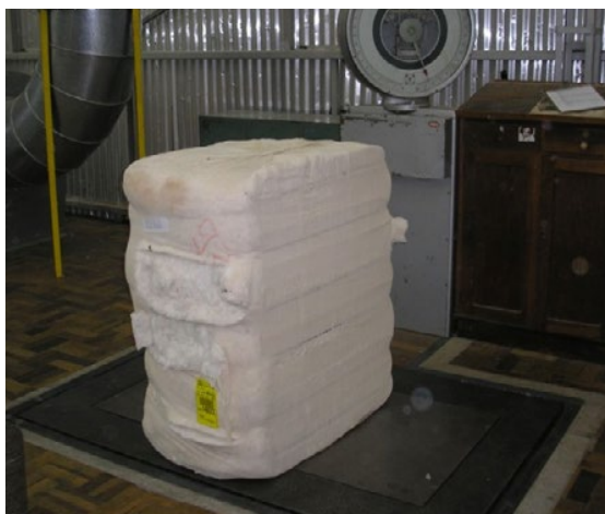
Figura 6. Pesagem fardo a fardo e pesagem por diferença de pesos da carreta carregada de fardos e da carreta vazia (Foto: J. J. de Lima)
