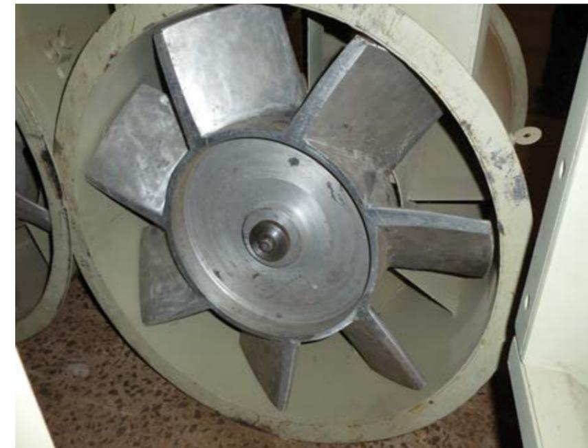
**Figura 8.17.** Ventilador axial de palhetas. (Foto: Cotimes, 2007).
