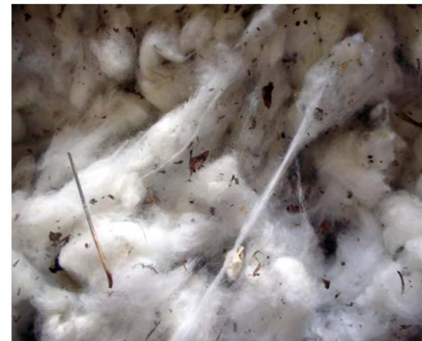
**Figura 7.5.** Mechas de fibra beneficiada pelo desmanchador. (Foto: Cotimes, 2005).
