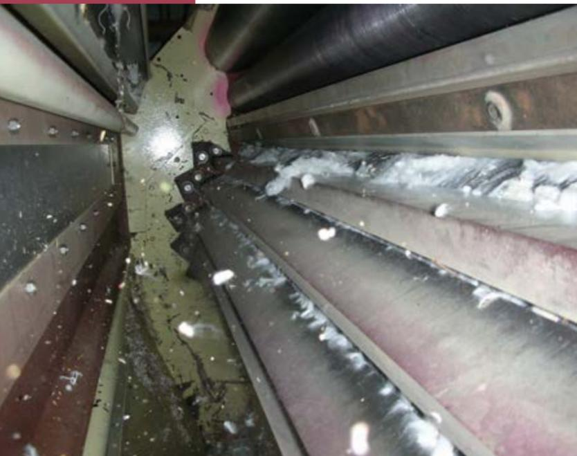
**Figura 7.76.** Perda de fibra por folga flutuante/barra excessiva. (Foto: Cotimes do Brasil, 2008).
