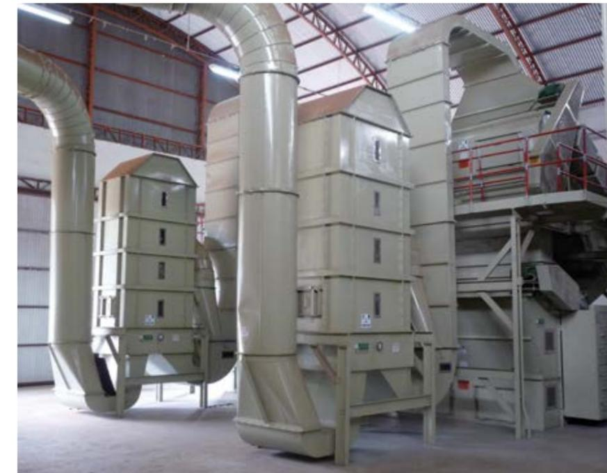
**Figura 7.23.** Sistema de secagem de uma usina moderna. (Foto: Cotimes do Brasil, 2011).
