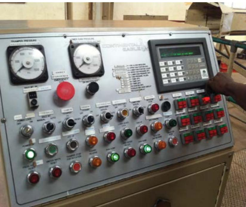
**Figura 10.2.** Painel de controle de prensa.
