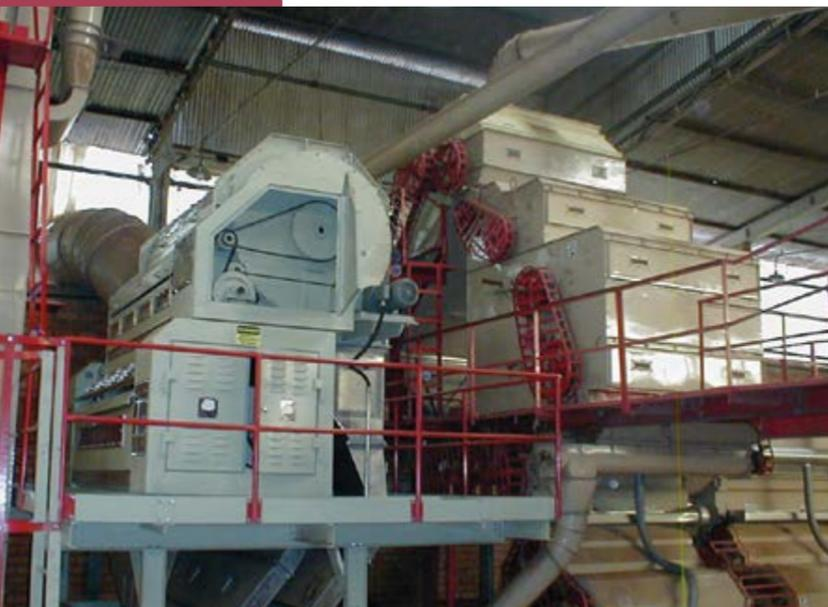
**Figura 7.83.** Limpeza de pluma moderna e dimensionada num processo antigo. (Foto: CIRAD, 2005).
