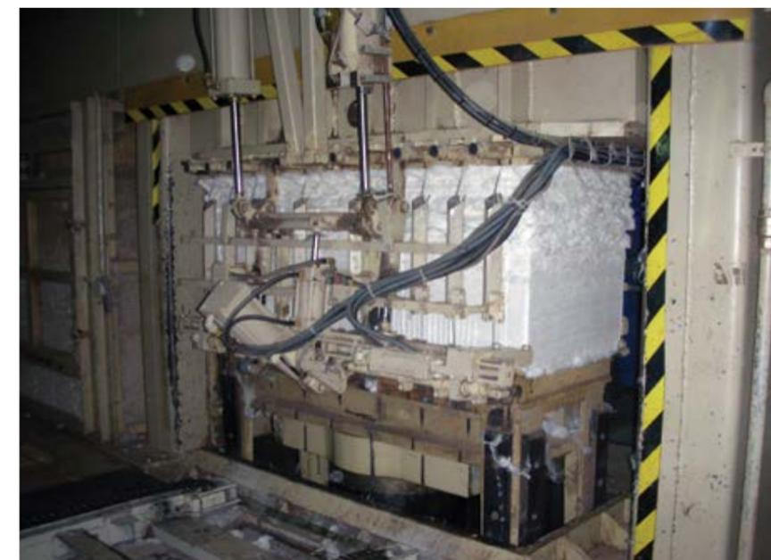
**Figura 7.101.** Sistema de amarração automática com arames. (Foto: Cotimes, 2011).
