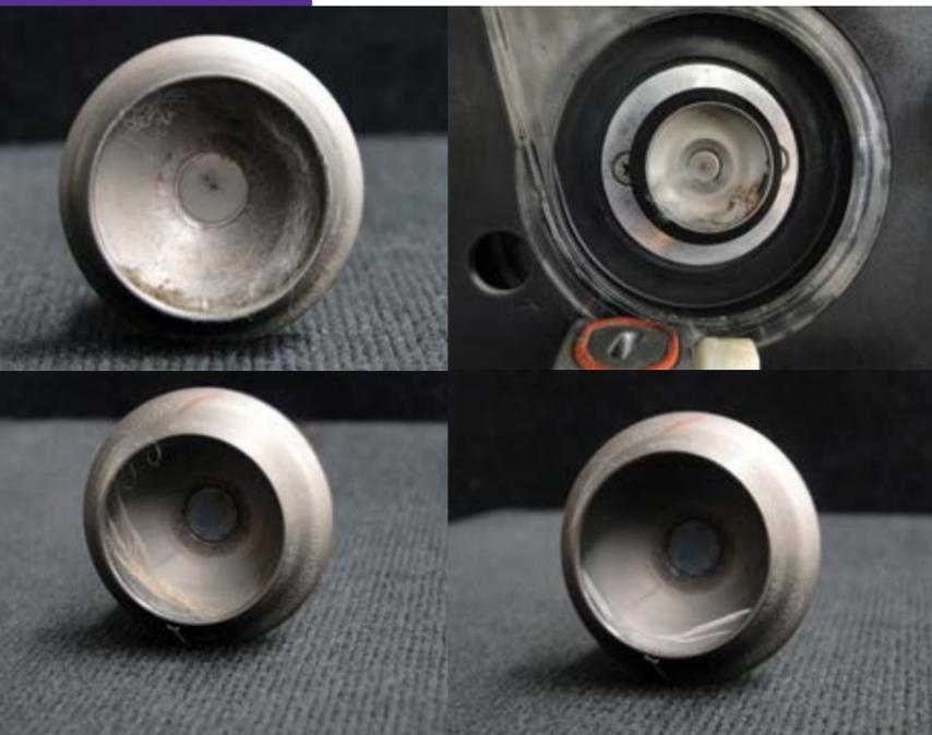
**Figura 16.8.** Presença de micropó, caule, juta e polipropileno nos rotores de fiação. (Foto: Jorge José de Lima, 2011).
