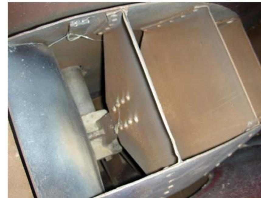
**Figura 8.13.** Rotor de palhetas curvas radialmente. (Foto: Cotimes do Brasil, 2009).
