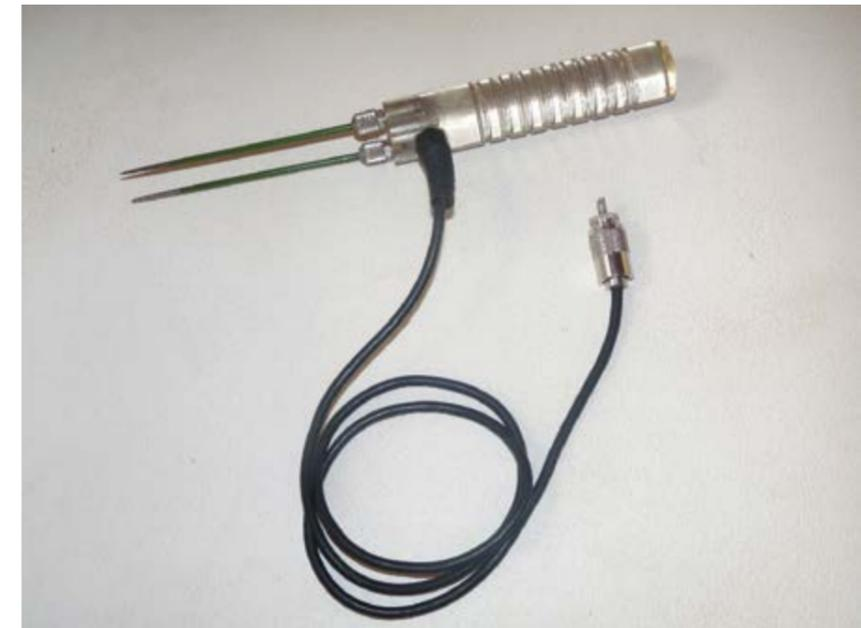
**Figura 19.4.** Eletrodo ponteiro.
