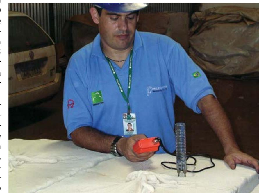
**Figura 7.34.** Controle manual da umidade da fibra no fardo. (Foto: Cotimes, 2005).
