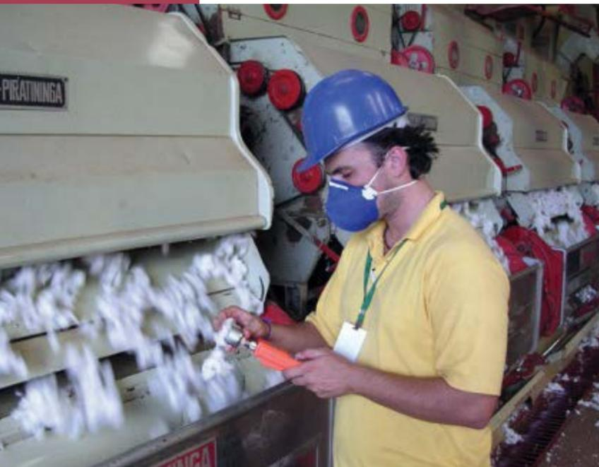
**Figura 7.29.** Controle manual da umidade do algodão em caroço nos alimentadores. (Foto: Cotimes, 2005).
