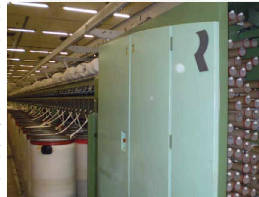
**Figura 16.16.** Filatório de rotor, fitas de alimentação e bobinas de fios produzidos. (Foto: Jorge José de Lima, 2011).
