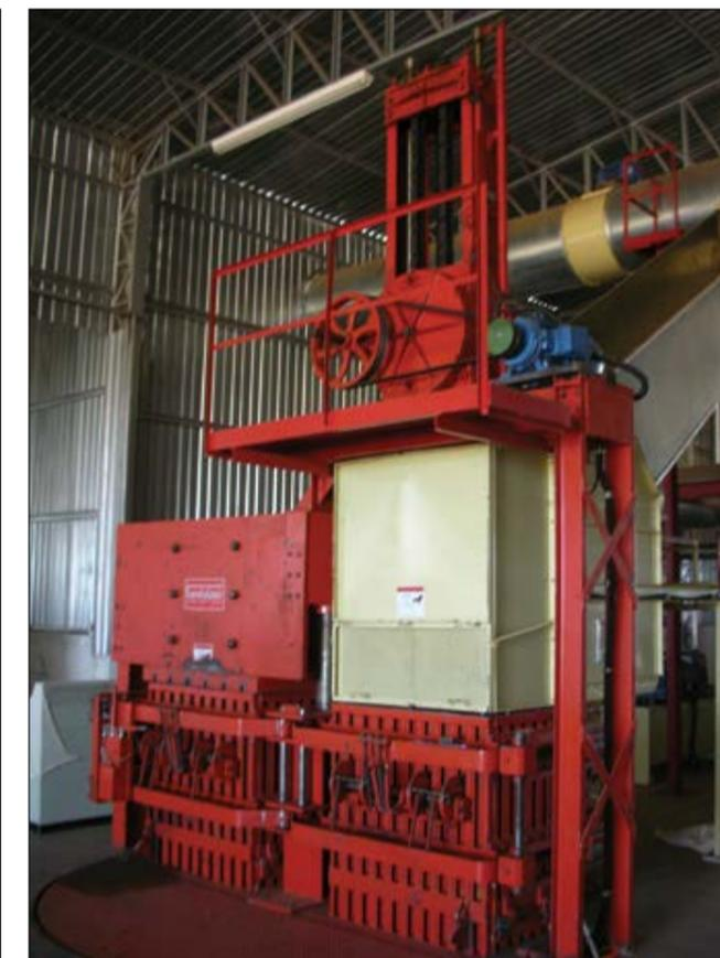
**Figura 7.91.** Prensa *up-packing* antiga.
