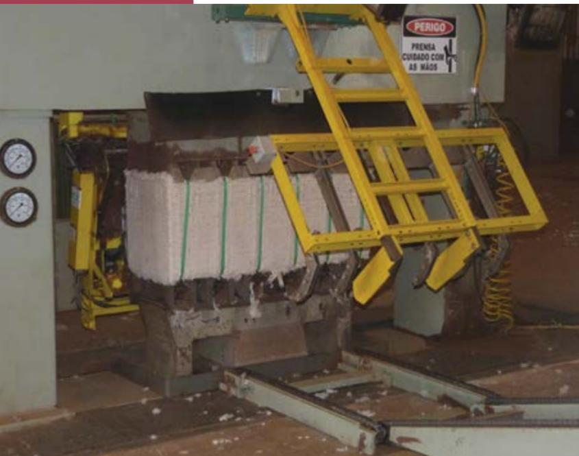
**Figura 7.102.** Sistema de amarração automática com fita. (Foto: Cotimes do Brasil, 2011).
