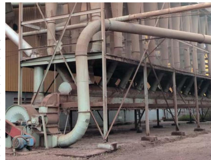
**Figura 8.26.** Transportador de corrente em baixo de ciclones. (Foto: Cotimes do Brasil, 2011).
