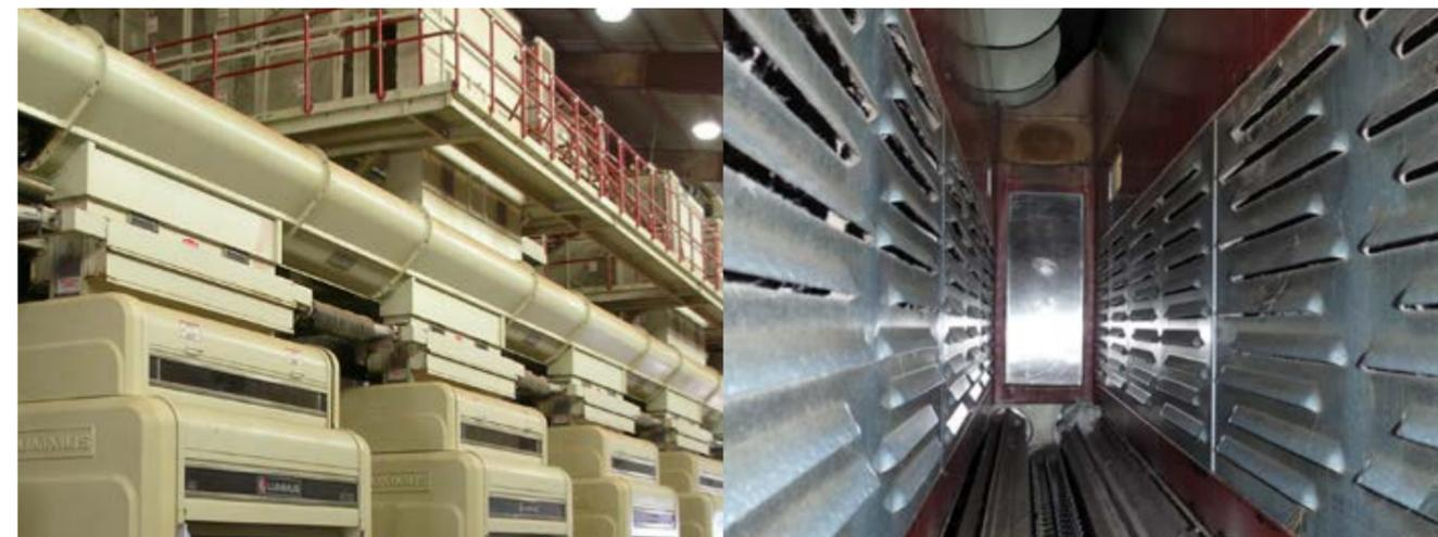
**Figura 7.28.** Caixa de umidificação do algodão em caroço (aspecto exterior e interior). (Foto: Cotimes do Brasil, 2009-2010).
