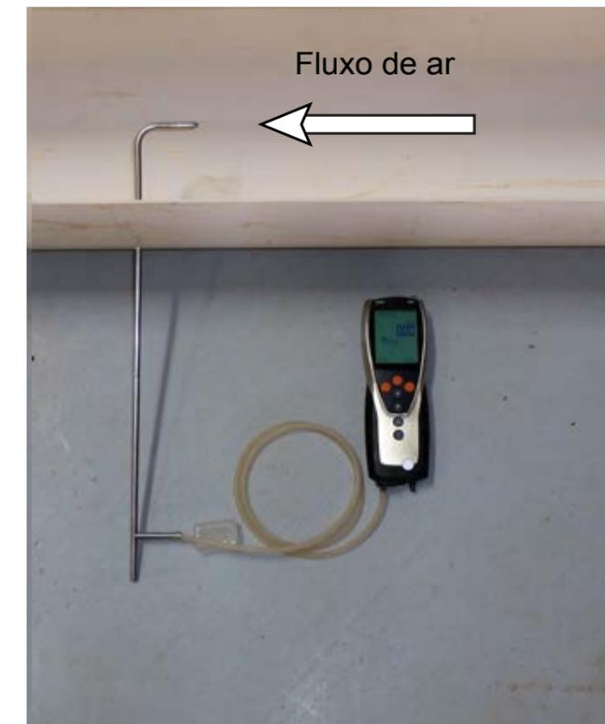
**Figura 8.7.** Medição de  $P_e$  com tubo de Pitot. (Foto: Cotimes do Brasil, 2011).
