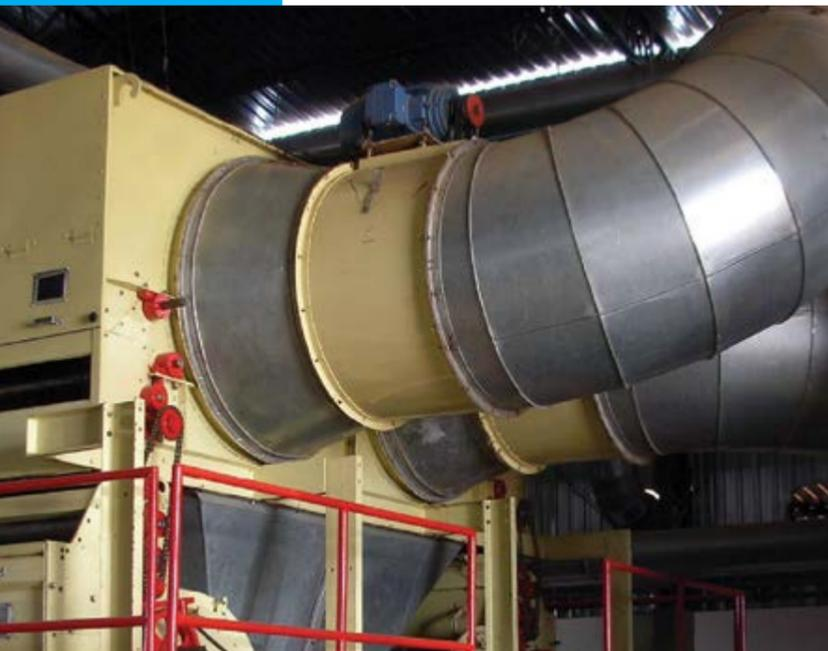
**Figura 8.15.** Ventilador axial de condensador. (Foto: Cotimes, 2007).
