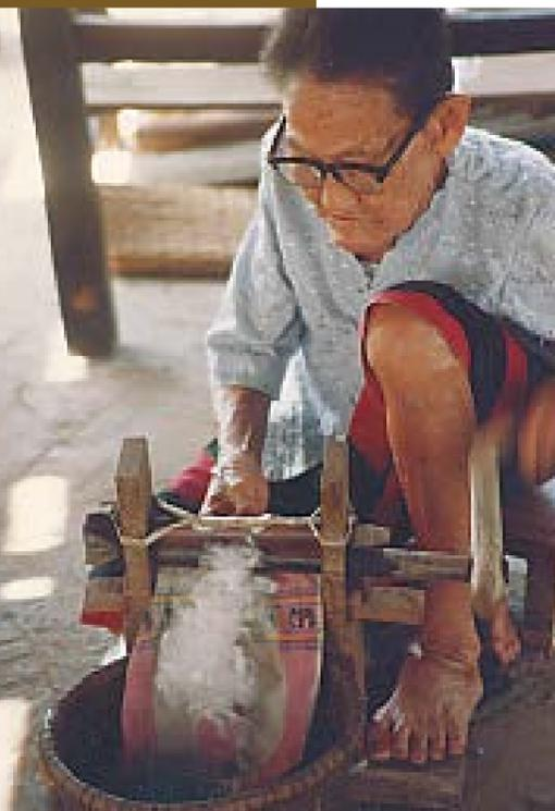
Figura 1.1. Modelo de Churka oriental. (Foto: CIRAD, [19--]).
