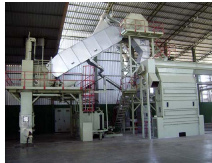
**Figura 12.4.** Condensador geral e bica da prensa. (Foto: Cotimes do Brasil, 2010).
