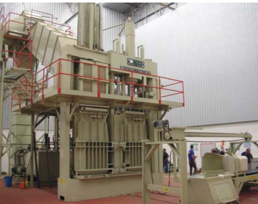
**Figura 7.94.** Prensa de caixas suspensas. (Foto: Cotimes do Brasil, 2008).
