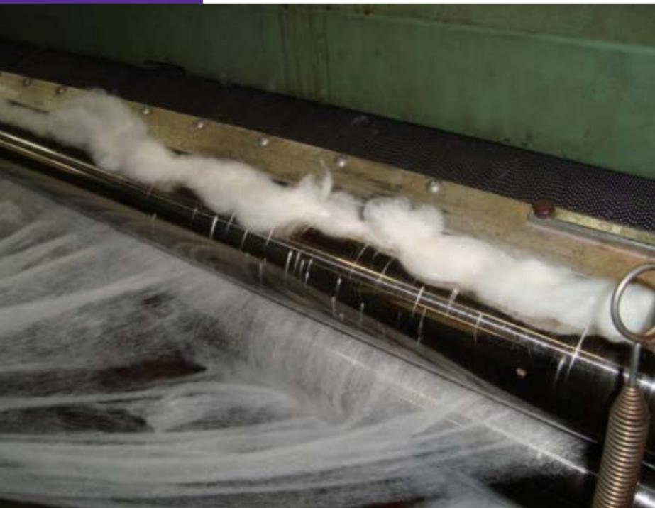
**Figura 16.2.** Aderência das fibras nas calandras de pressão da carda devido a materiais pegajosos. (Foto: Jorge José de Lima, 2011).
