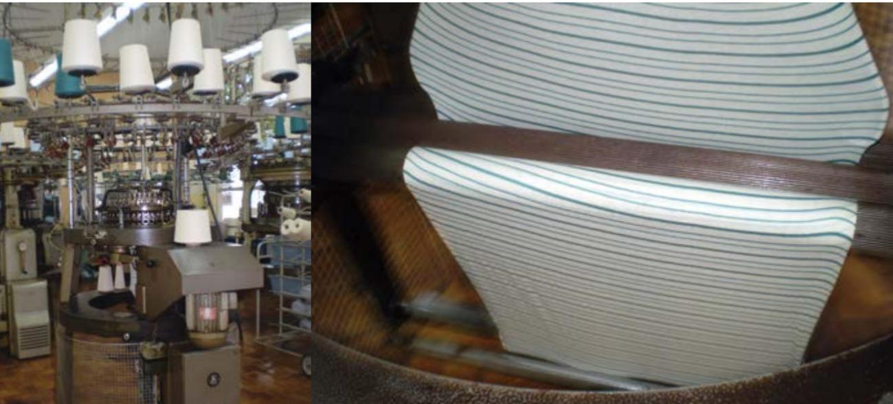
**Figura 16.21.** Tear circular alimentado por cones de fios e tecido de malha por trama em produção. (Foto: Jorge José de Lima, 2011).
