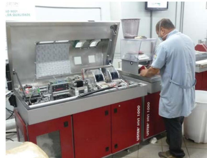
**Figura 15.5:** Inspeção e manutenção preventiva do instrumento HVI. (Foto: Cotimes do Brasil, 2011).
