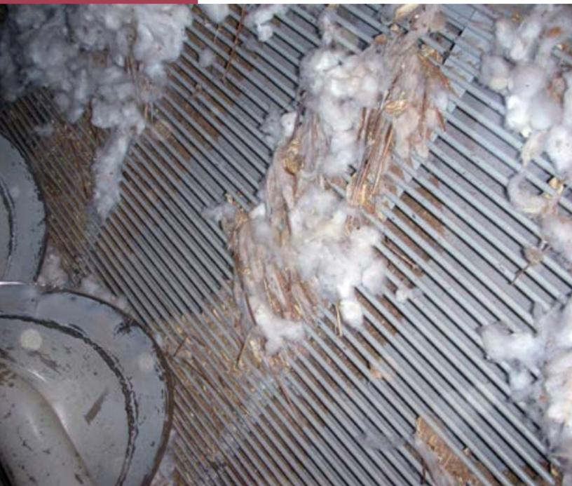
**Figura 7.6.** Troca da chapa traseira por grelha. (Foto: Cotimes, 2006).
