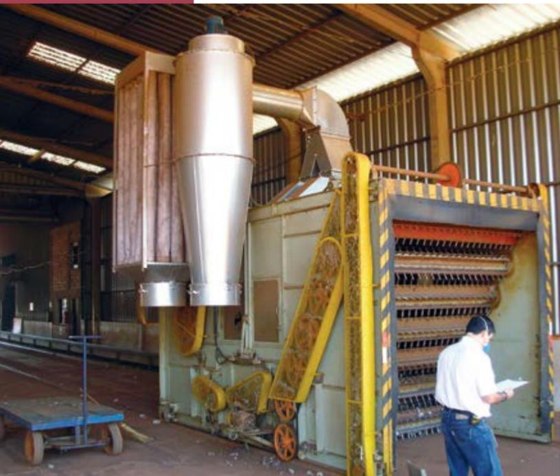
**Figura 7.7.** Sistema de catação de poeira no desmanchador móvel. (Foto: Cotimes do Brasil, 2008).
