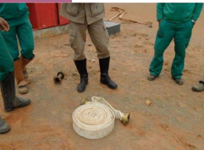
**Figura 5.12.** Mangueira com diâmetro de 50 mm. (Foto: SLC Agrícola, 2011).
