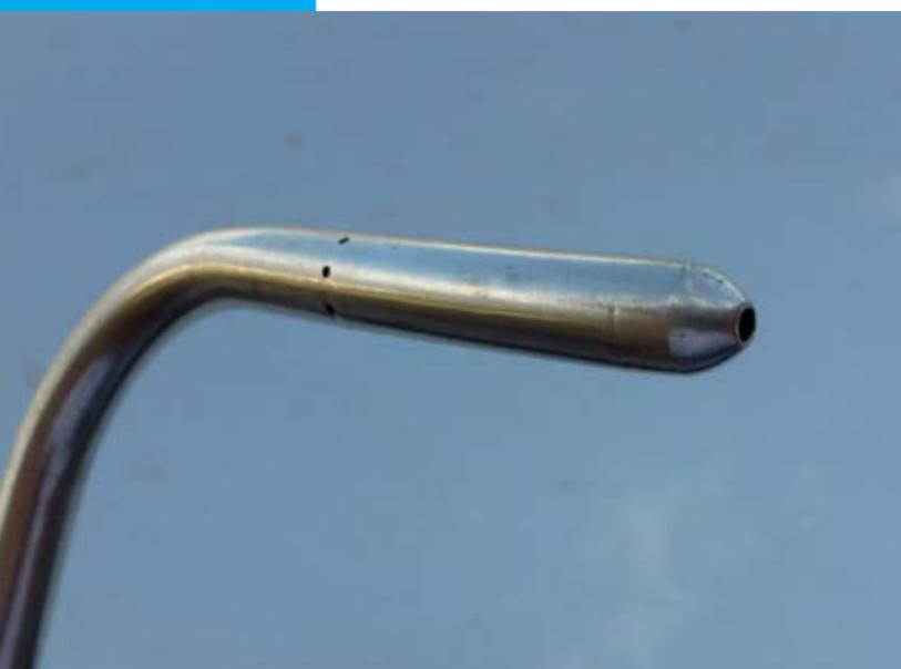
**Figura 8.5.** Detalhes do tubo de Pitot. (Foto: Cotimes do Brasil, 2012).
