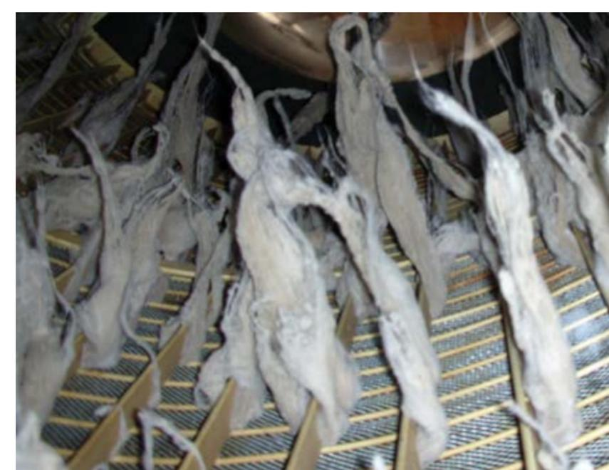
**Figura 8.18.** Condensador entupido. (Foto: Cotimes, 2007).
