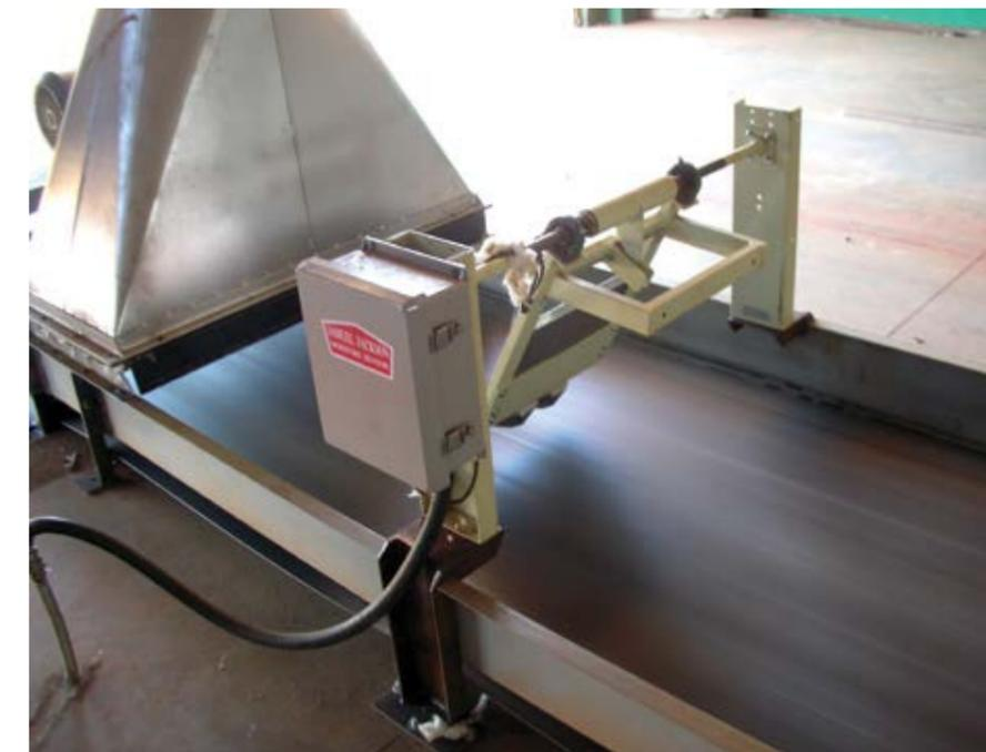
Figura 7.25. Sensor de umidade na esteira do desmanchador. (Foto: Cotimes, 2006).
