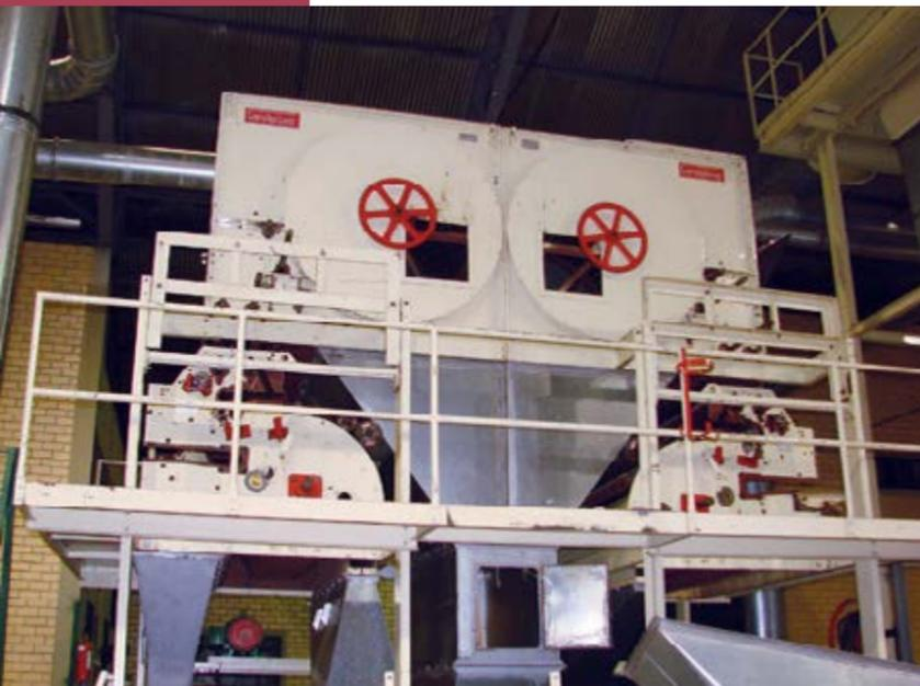
**Figura 7.74.** Limpa-pluma duplo de 66", com fluxo dividido. (Foto: Cotimes, 2007).
