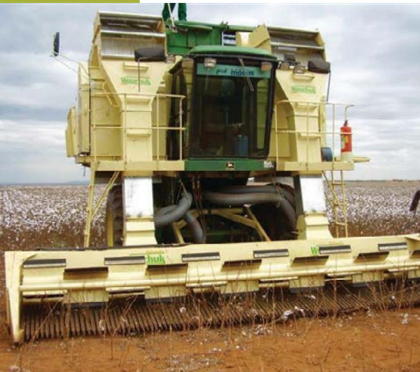
**Figura 2.2.** Colheita do algodão adensado com máquinas de pente. (Foto: Emilio Pereira, 2009).
