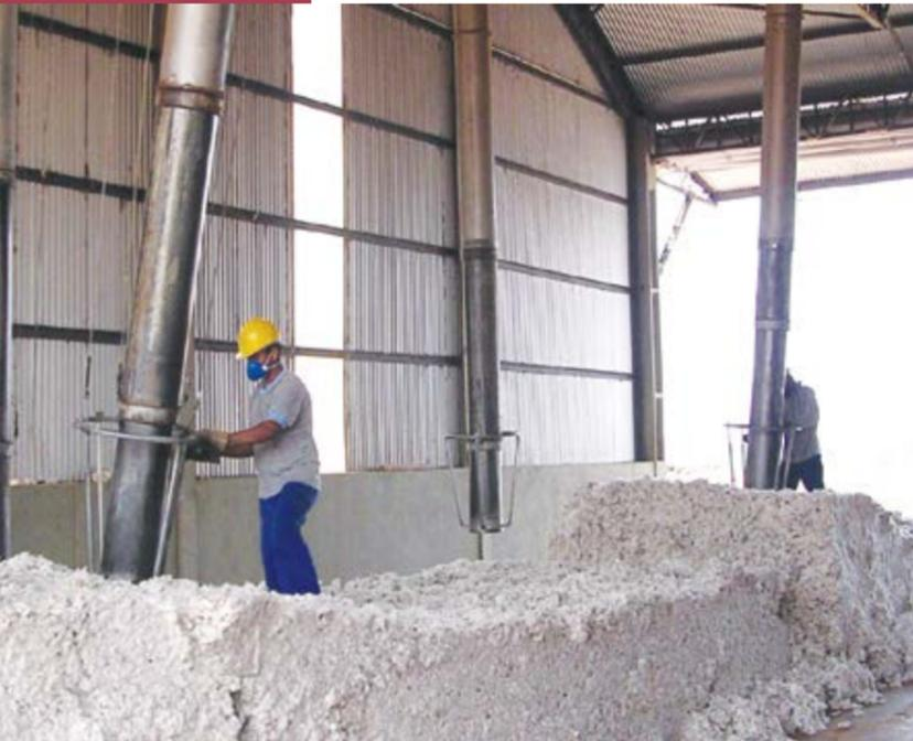
**Figura 7.8.** Descarregamento por telescópio manual. (Foto: Cotimes, 2004).
