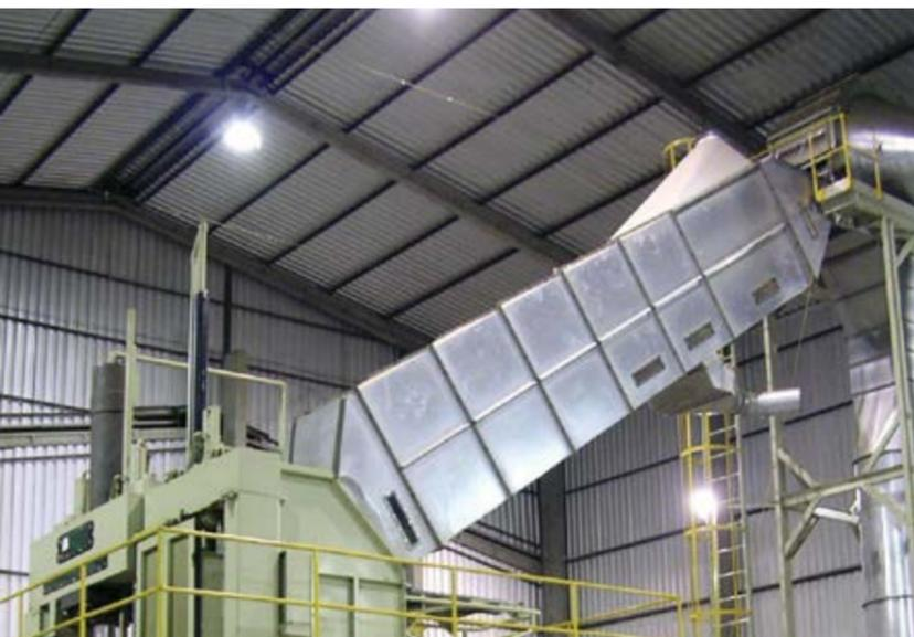
**Figura 7.86.** Bica do condensador.
