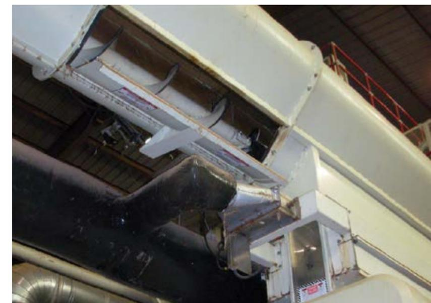
**Figura 8.22.** Calha de rosca distribuidora. (Foto: Cotimes do Brasil, 2009).
