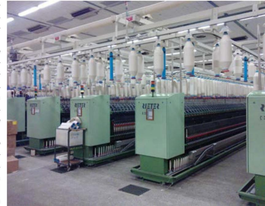
**Figura 16.15.** Filatório de anéis com pavios de alimentação e fios em produção. (Foto: Jorge José de Lima, 2011).
