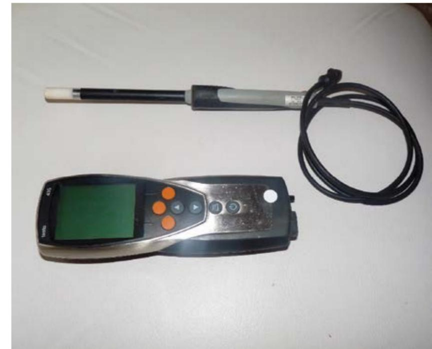
**Figura 19.7.** Termo-higrômetro digital.
